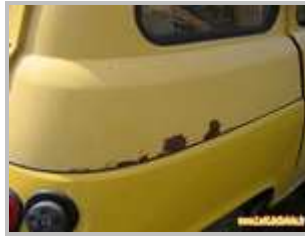
3 => ailes arrière : si on voit la corrosion à ce niveau c'est qu'elle s'est déjà bien développée à l'intérieur
