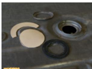
**Orifice de la jauge à essence :** j'ai remplacé la platine de la jauge à essence par un joint de la même épaisseur. Dans la mesure du possible c'est encore mieux de mettre à la place une plaque transparente genre plexiglas afin de pouvoir suivre l'application du traitement.
