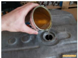
Verser l'intégralité de la résine mélangée dans le réservoir.
