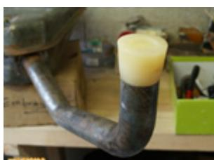
**Tube de remplissage :** je l'ai bouché avec un gros bouchon en silicone que j'ai choppé à mon travail, fastoche! Sinon il faut essayer de la boucher avec un morceau de gant de vaisselle et un peu de Scotch par exemple en essayant de laisser le moins de volume mort possible.
